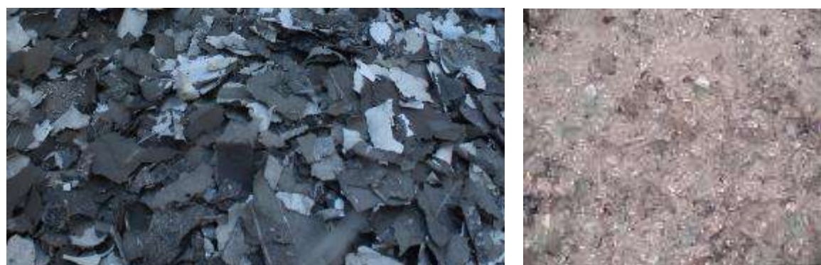
Figure 102 : Fragments de silicium et granulés de verre (source : Pvcycle, 2015)
