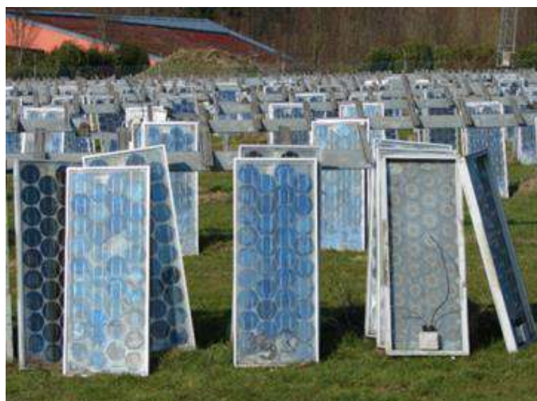
Figure 100 : Panneaux photovoltaïques en fin de vie (source : Soren, 2015)
