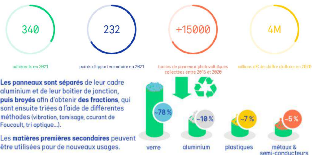
Figure 101 : Le traitement des panneaux photovoltaïques (source : Soren, 2022)
