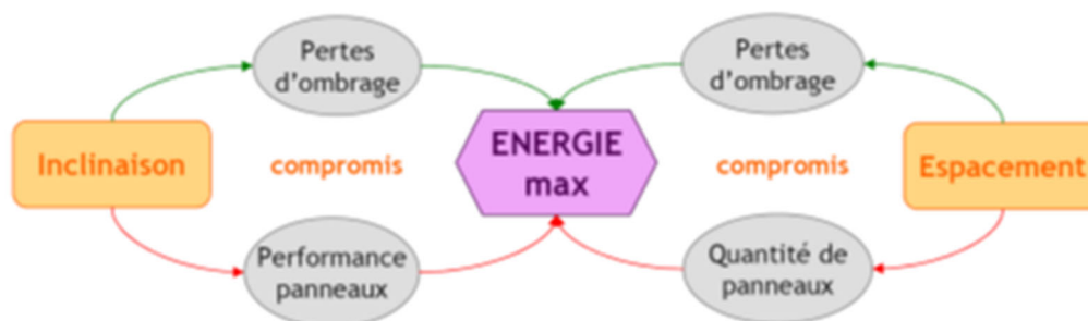
Schéma d'optimisation des implantations de panneaux photovoltaïques
