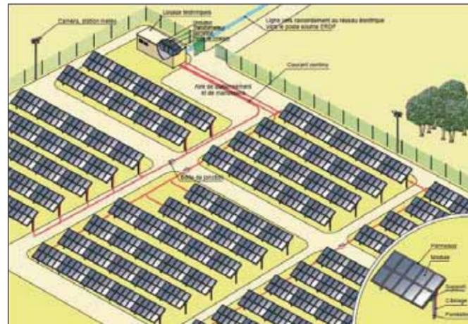
Figure 3 : Schéma de principe d'une installation photovoltaïque (Source : Guide du MEDDE)
